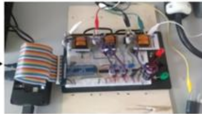
Interfaz de comunicación (acondicionamiento de señal)
